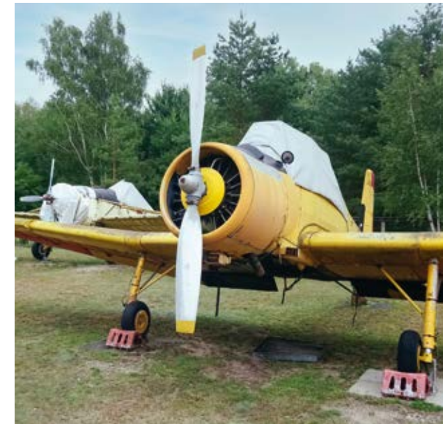
LET Z-37 Čmelák, ein tschechisches Mehrzweckflugzeug, das u. a. als Agrar-, Schlepp-, Transport- und Feuerlöschflugzeug diente. Die hier abgebildete Serienversion Z-37A wurde ab 1965 bis Ende der 1970er Jahre gebaut.
